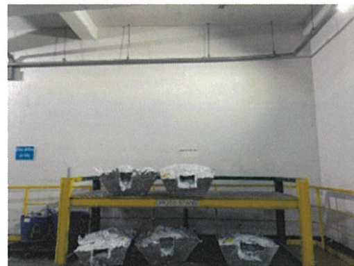
รูปที่ 3-22 ภาชนะและพื้นที่เก็บรวบรวม กากตะกอนสังกะสี
