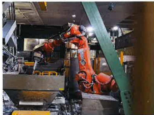
รูปที่ 3-42 หุ่นยนต์ทำงานในบริเวณ ที่มีอุณหภูมิสูงและแสงจ้า
